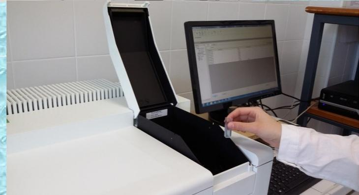
Spettrofotometria di assorbimento molecolare, analisi svolte nel campo del visibile (fosfati, nitriti e ammonio) e UV (nitrati).
