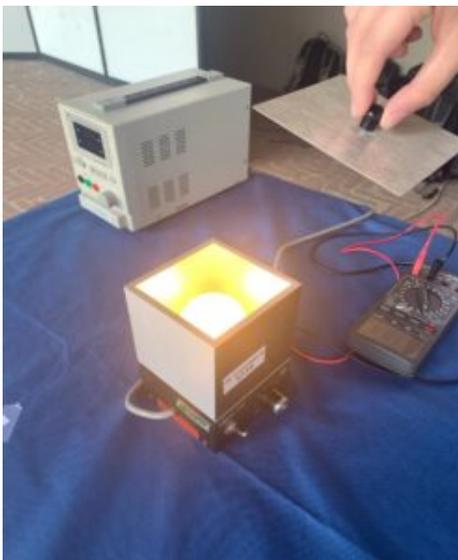
Per dimostrare le variazioni della radiazione termica è necessario inserire all'interno del cubo una sorgente di calore, che può essere una lampada di riscaldamento o un po' di acqua calda. Il cubo di Leslie è un contenitore costituito da un conduttore metallico utilizzato per misurare e dimostrare le variazioni della radiazione termica emessa da superfici diverse alla stessa temperatura. Le superfici sono di quattro tipi: nera, bianca, lucida ed opaca.
